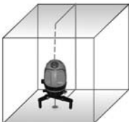
Projette une ligne verticale vers l'avant et un point d'aplomb
